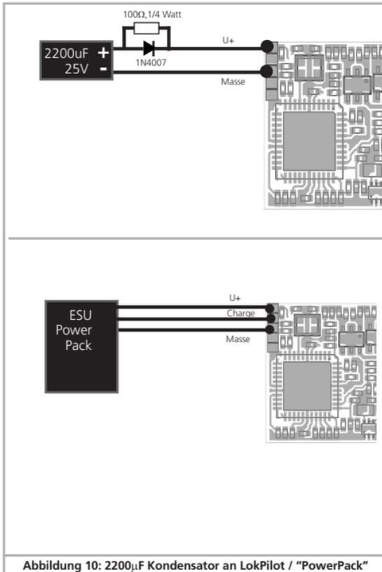
Abbildung 10: 2200µF Kondensator an LokPilot / "PowerPack"
