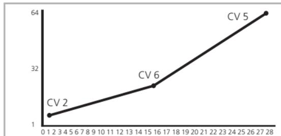
Abbildung 11: Geschwindigkeitseinstellung mit CV 2, 6, 5
