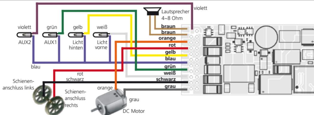
Abbildung 5: Allgemeines Anschlussschema LokSound V4.0 (Beispielverdrahtung)
