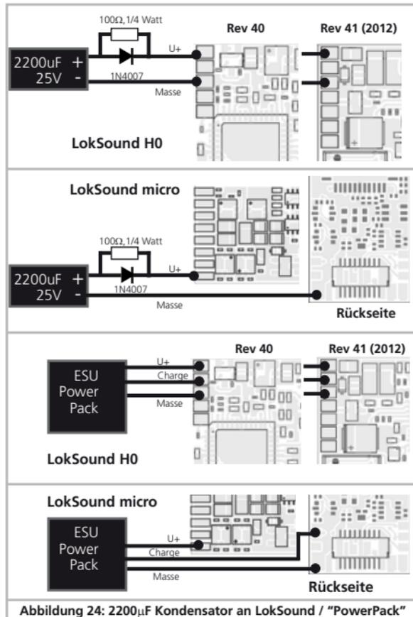
Abbildung 24: 2200µF Kondensator an LokSound / "PowerPack"
