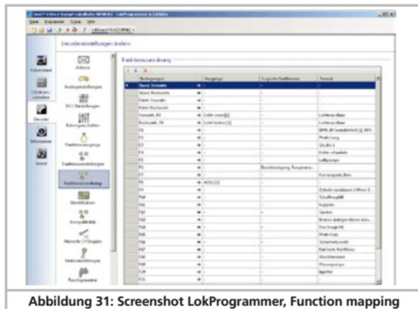
Abbildung 31: Screenshot LokProgrammer, Function mapping
