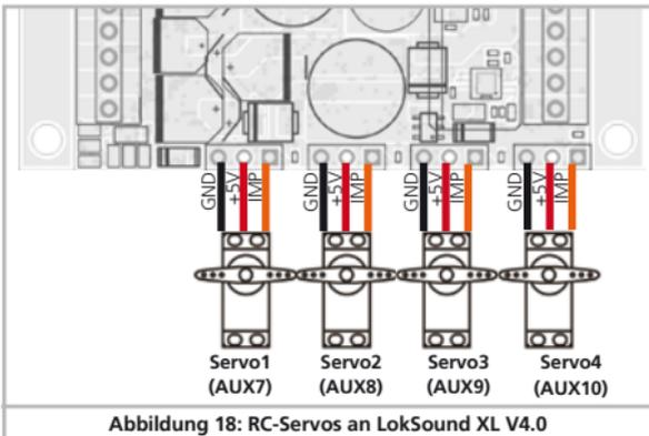
Abbildung 18: RC-Servos an LokSound XL V4.0
