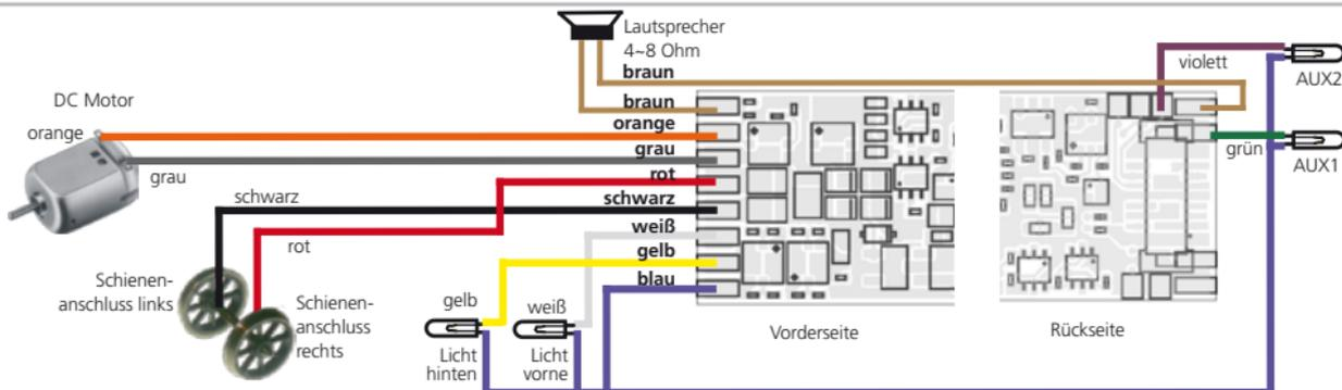
Abbildung 6: Allgemeines Anschlussschema LokSound micro V4.0 (Beispielverdrahtung)
