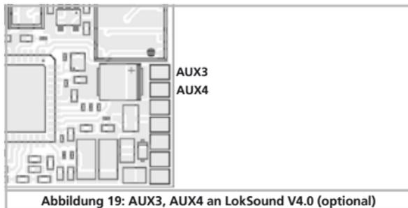
Abbildung 19: AUX3, AUX4 an LokSound V4.0 (optional)
