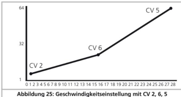
Abbildung 25: Geschwindigkeitseinstellung mit CV 2, 6, 5
