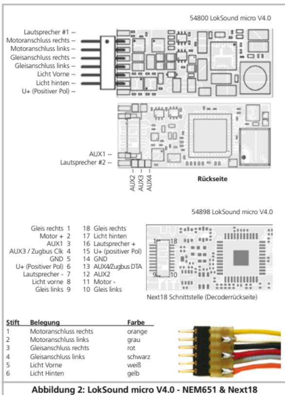
Digitalschnittstelle nach NEM651 geliefert (vgl. Abb. 2). Der Einbau in Loks mit passender Schnittstelle ist besonders einfach:
