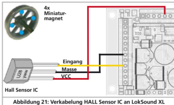
Abbildung 21: Verkabelung HALL Sensor IC an LokSound XL
